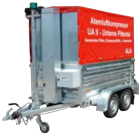
Feuerwehr Sonderanhänger mit Atemluft-aggregat
