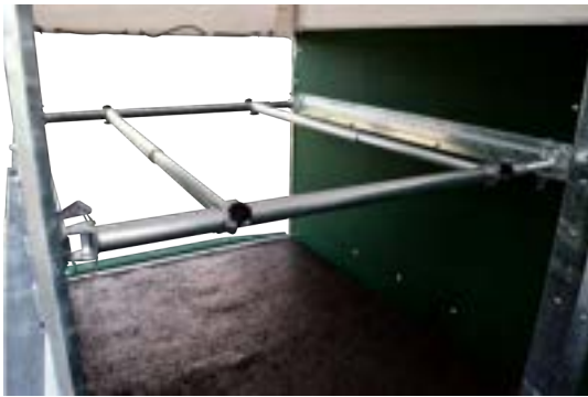
Innenansicht: Teleskopstangen zum Einzeltiertransport
