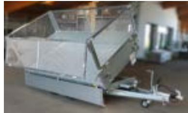
Gitteraufsatzwandgarnitur, 800mm hoch, allseitig klapp- und abnehmbar, Stahl verzinkt MW 30/30
