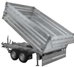
Bordwände Stahl, Höhe 400mm, Aufbau- und Aufsatzwandgarnitur sind 3-seitig klapp/pendelbar, alle Wände abnehmbar, Eckrungen gesteckt
